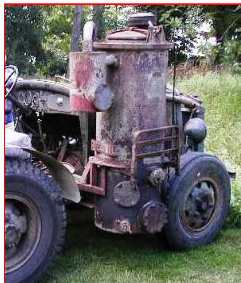
rechts; voorbeeld opgebouwde gasgenerator op een tractor
